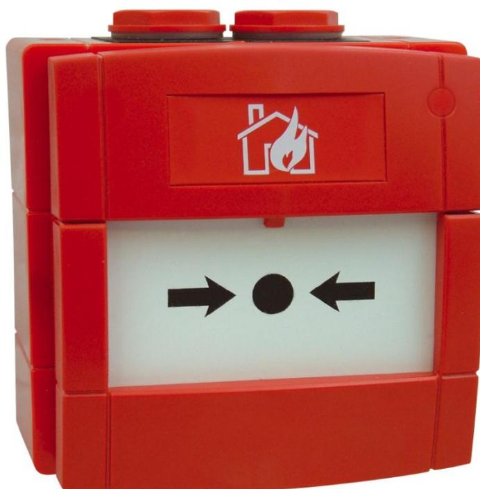
Les déclencheurs manuels WCP1A-R470SF-01 et WCP3A-R000SF-01 sont conformes à EN54-11 et IP67 étanche pour des applications extérieures. Grâce aux connecteurs coulissants, l'installation est très pratique. Le déclencheur dispose de 3 entrées de câble de 20 mm et d'une fonction anti-sabotage. Il existe des versions avec différentes configurations de contacts.
