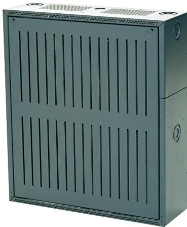
Le boîtier d'alimentation PSB 0004 A dispose de suffisamment d'espace pour accueillir jusqu'à quatre batteries 12 V/28 Ah. Il est également possible d'installer un support d'alimentation et un distributeur de puissance et/ou un support d'alimentation et une plaque de montage à la place des deux batteries supérieures.
