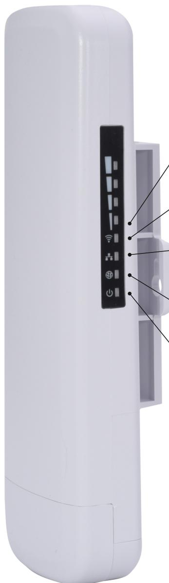
Jauge d'intensité du signal entre les deux antennes.
