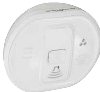
*Lorsque le détecteur-avertisseur est activé, le bouton de test permet d'arrêter la sirène pendant 4 minutes. Si la concentration de monoxyde de carbone est supérieure à 150 ppm, la sirène ne peut être arrêtée, même en appuyant sur ce bouton.*
