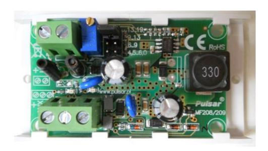
Le convertisseur DCDC10 transforme une tension de max 28 Vcc en une tension de niveau inférieure. La tension de sortie peut être sélectionnée à l'aide d'un cavalier. En mode d'usine il convertit 24Vcc, typiquement provenant d'une centrale d'incendie, en 12Vcc pour alimenter par exemple un transmetteur téléphonique.
