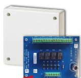
Universeel interfacekaart met 4 relais met box voor GalaXy • Stroomvoorziening: 8,5 tot 16V • Weerstand: 280 Ohm (42mA) • Contactspanning max. 125 VAC / 150 VDC
