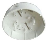
Base supplémentaire apparent avec 2 entrées jusqu'à 28mm pour des détecteurs incendie Bosch des séries 320 et 420. Dimensions D 120mm x H 36,7mm. Pour assurer une protection contre la pénétration de condensation d'eau, un joint en TPE est situé à la base du socle MSC 420
