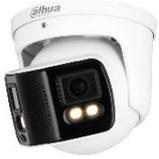
• Caméra réseau Turret WizMind 2x 4MP Full Color Duo 180° avec 2 objectifs 3.6mm • Resolution max. 8MP@25fps • WDR 140dB • Lumière blanche jusqu'à 40m • ePTZ, SMD 4.0 • Alarm: 1E/1S, audio: 1E/1S, emplacement pour carte microSD max. 512Gb • Microphone et haut-parleur intégrés • Fonctions intelligentes: voir fiche technique • IP67 • 12VDC/PoE/ePoE
