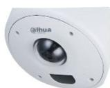
• Caméra d'angle IP 4MP • Objectif focale fixe 2.5mm • 30ips@4MP • Starlight • Jour/nuit ICR • WDR 140dB • Max. IR 10m (940nm) • 1E/1S alarme • 1E/1S audio • Emplacement microSD • IK10+50J/IP67 • 12VDC/POE
