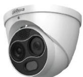
• Caméra turrett thermique hybride IP • 4MP-25ips/256x192 thermique • Objectif 8mm (40°)/7mm (24°) thermique • IVS • Max. IR 30m • Série WizSense • Jour/nuit ICR • DWDR • Emplacement carte microSD (max. 256GB) • 1E/1S alarme • 1E/1S audio • IP67 • 12VDC • POE IEEE 802.3af • 13W
