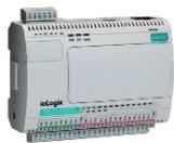
Entrées numériques : 12 canaux • Sorties numériques : 8 canaux • Courant nominal : 200 mA par canal • Ethernet : 1 x 10/100 Mbps, RJ45 • Protocoles : Modbus/TCP, TCP/IP, UDP, DHCP, Bootp, SNMP, HTTP, CGI, SNTP, SMTP • Dimensions : 115 x 79 x 45,6 mm • Alimentation : 24 VDC nominal, 12 à 36 VDC • Consommation électrique : 203 mA @ 24 VDC
